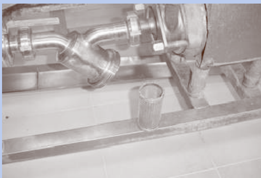
ภาพที่ 59 : อุปกรณ์กรองน้ำนมก่อนเข้าสู่ปั๊ม
