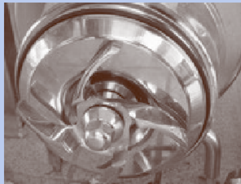
ภาพที่ 98 : ใบพัดภายใน Sanitary Pump
