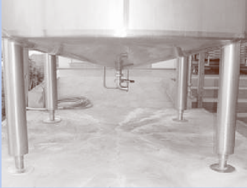
ภาพที่ 50 : ก้นถังที่ลักษณะเป็นกรวย ลาดเอียง
