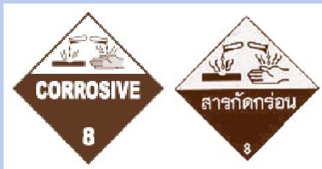
ภาพที่ 167 : สัญลักษณ์ของสารที่มีฤทธิ์กัดกร่อน
