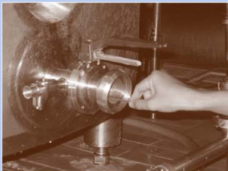
ภาพที่ 191. : การ Swab Test วาล์วหน้าถังรอบบรรจุ
