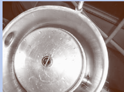
ภาพที่ 86 : ลูกลอยภายในถังควบคุมระดับ
