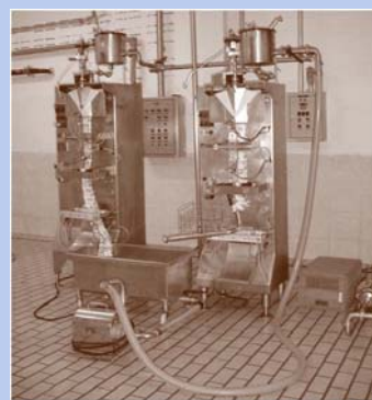
ภาพที่ 177 และ 178 : การล้างเครื่องบรรจุด้วยวิธี CIP
