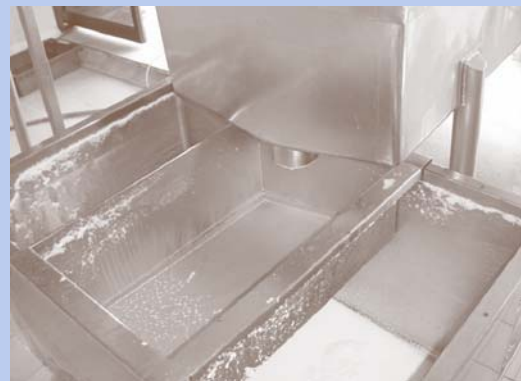
ภาพที่ 8 : อ่างรับน้ำนมดิบ
