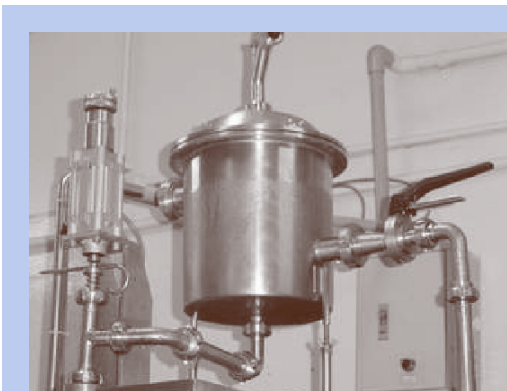
ภาพที่ 85 : ถังควบคุมระดับเครื่องบรรจุ
