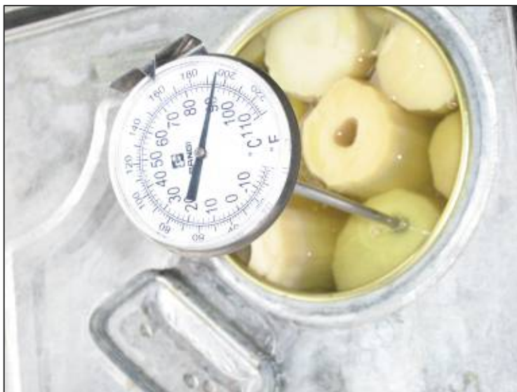
ภาพที่ ข23 การวัดอุณหภูมิการต้มฆ่าเชื้อหน่อไม้ปืบ
