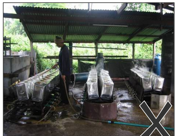
ภาพที่ ข22 การต้มปืบโดยตรงกับเปลวไฟ
