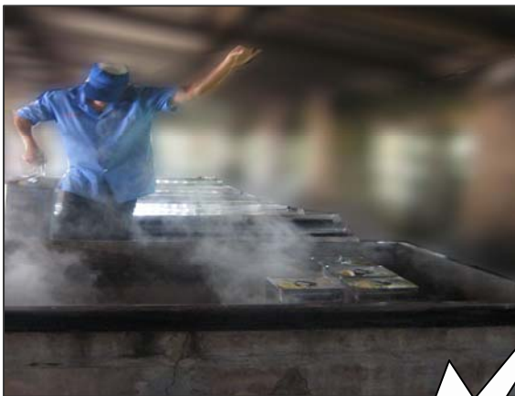
ภาพที่ ข21 การต้มฆ่าเชื้อหน่อไม้ปืบในอ่างต้ม
